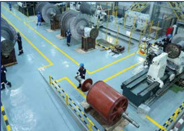
إعادة تأهيل التوربينات البخارية ومولدات الكهرباء لمحطات توليد القوى الكهربائية وتقطير المياه مع وزارة الكهرباء والماء والطاقة المتجددة.
